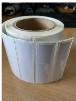
Das Crystal-TE-UHF Smart Label mit Sicherheits-Stanzung
